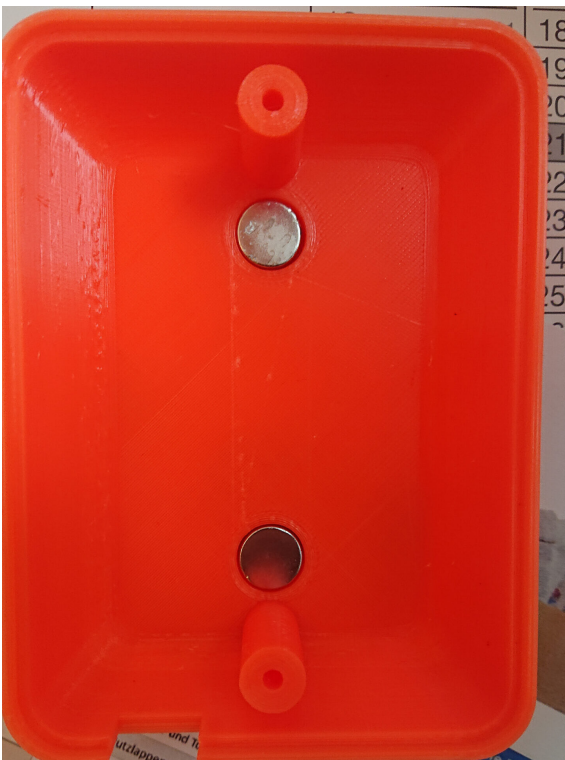
Sendereinheit: Magnete an der Rückwand halten die Einheit in der Ladeschale und auf anderen metallischen Flächen.
